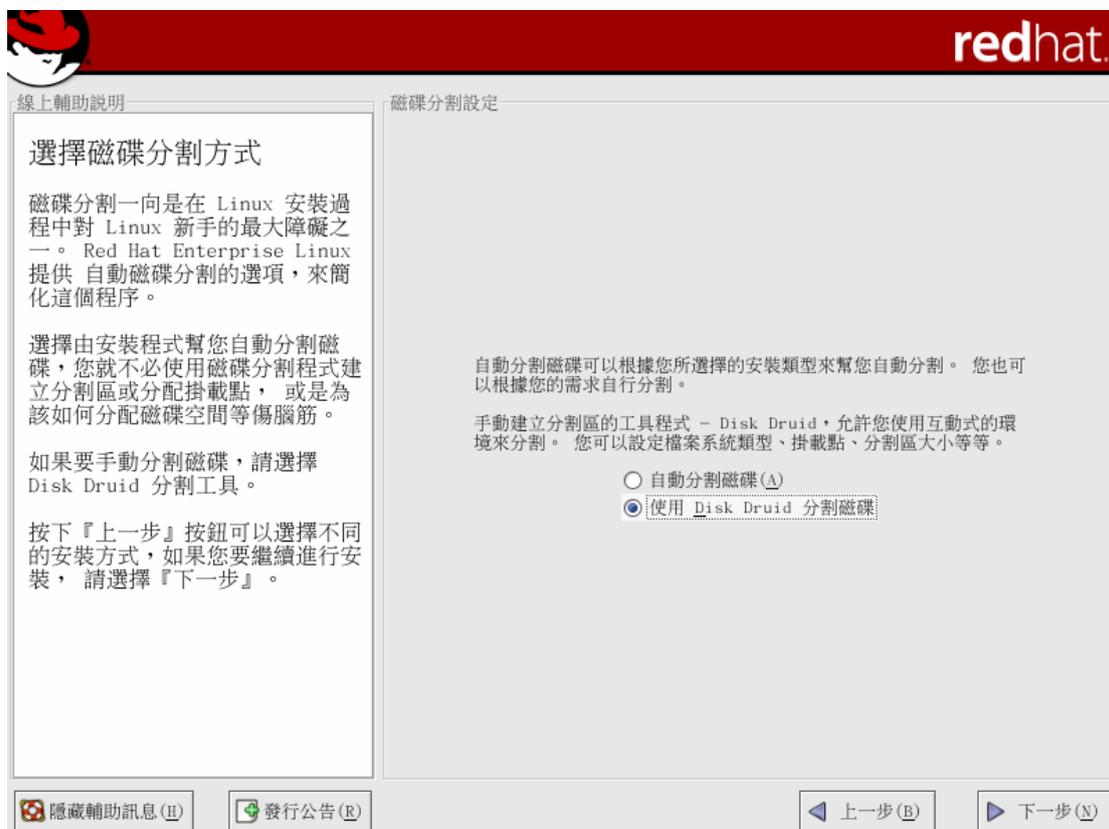
圖 5、選用 Disk Druid 來分割磁碟 (Disk Druid 只有在安裝時才可使用)
